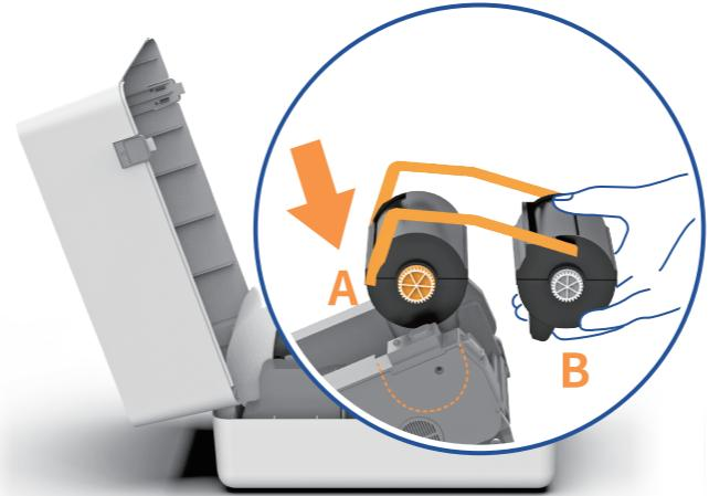
4 将供应端(B)向下旋转, 直到卡扣旋进B字孔, 听到“咔”声, 碳带盒安装完成
